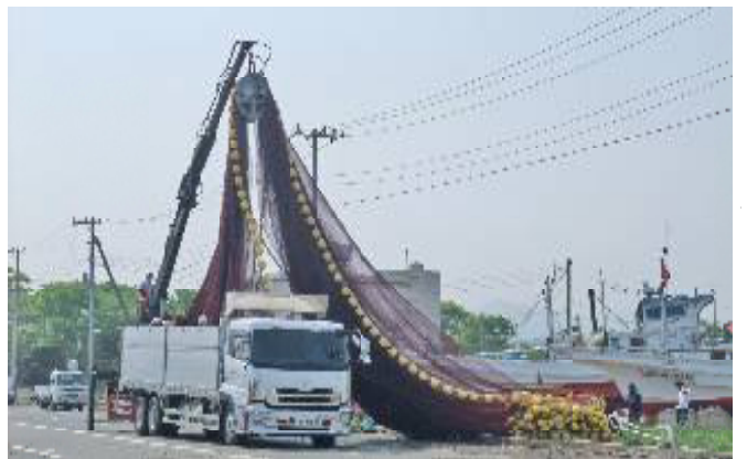
クレーンで持ち上げて、巻き網の確認作業。網は、幅200m、深さ150mあって、約1億数千万円します。操業には、この網が3つ必要になります。
